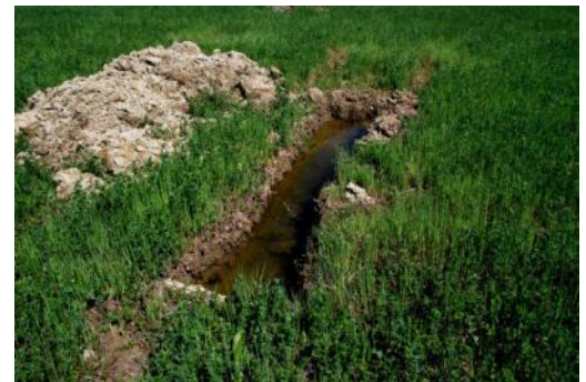
3. Sondaggi effettuati nella zona pianeggiante dell'area interessata. Sono profondi circa 50cm. L'acqua è acqua piovana.
